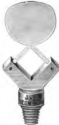
Doppelbrenner D. R. - G. - M. Nr. 86505 aus Speckstein mit Messinguntersatz mit seitlichen Luftzuführungslöchern.
